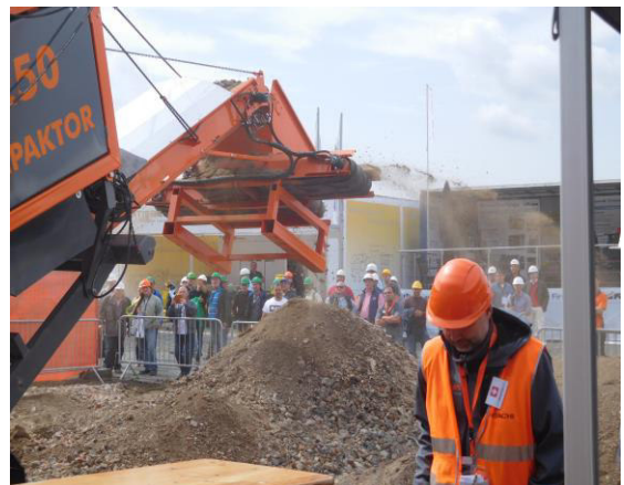
Слика 5.2.8-3. Машина/постројење за третман отпада од рушења и грађења (дробилница, магнетни сепаратор - слика лево и сито на крају конвејера (слика десно))
