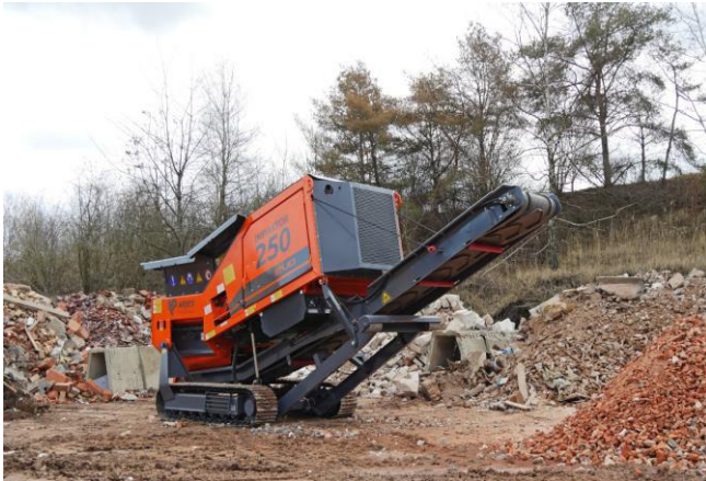
Слика 5.2.8-3. Машина/постројење за третман отпада од рушења и грађења (дробилница, магнетни сепаратор - слика лево и сито на крају конвејера (слика десно))
