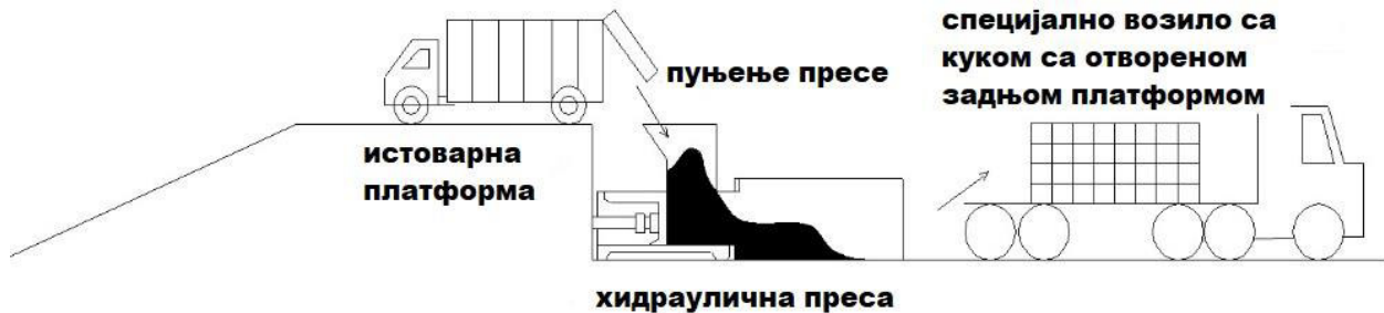
Слика 5.2.7-1: Принцип рада претоварне станице на трансфер станица
