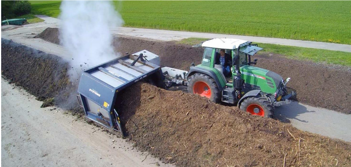
Слика 5.2.5-3. Трактор превртач у раду
